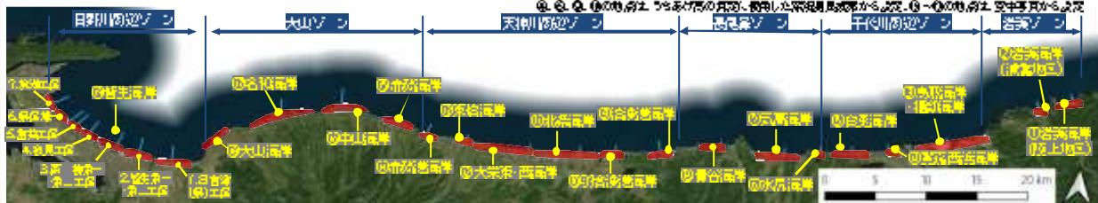
Brunn 則による汀線後退量の算出結果及び2100年時の想定砂浜幅
